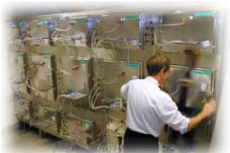
Produktmissionen werden in Prüfkammern aus Glas oder Edelstahl geprüft.
